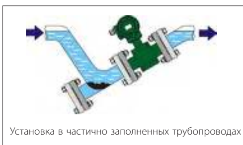
Расходомер устанавливается электронным блоком ВВЕРХ
